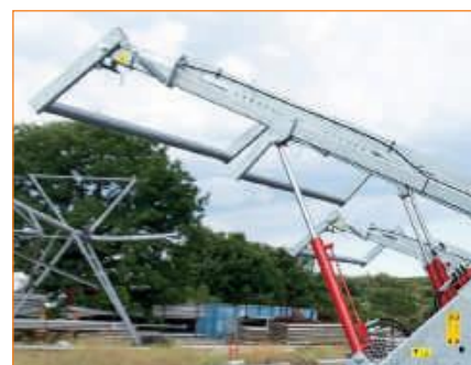
Cadre de relevage hydraulique
