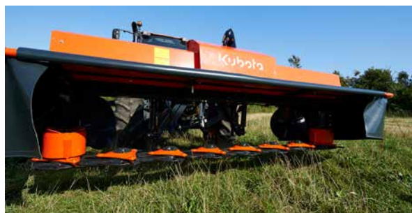
Accès rapide et facile au lamier grâce aux protections frontales et latérales repliables.
