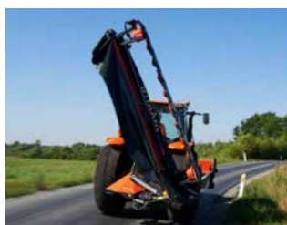
Position transport à 125° pour une excellente répartition du poids.
