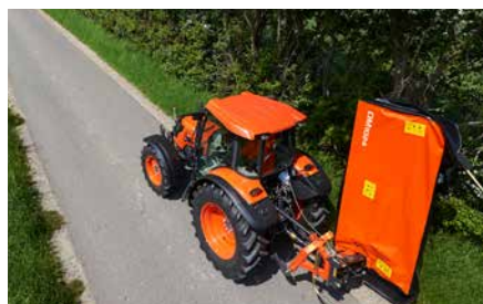
Position transport au plus près du tracteur.
