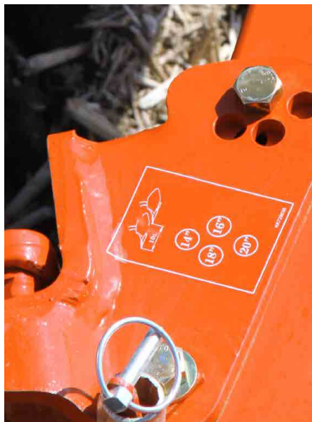
Réglage manuel facile de la largeur de travail pour les RM2000-RM2005. Un seul boulon à repositionner.
