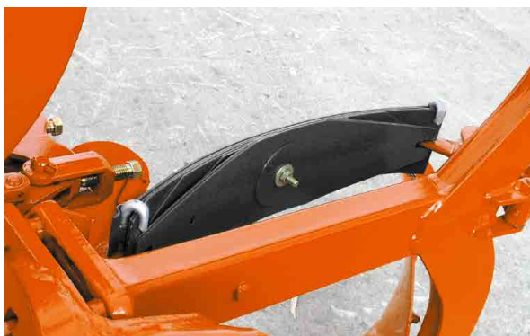
Montage HD avec 9 lames (900 kg)
