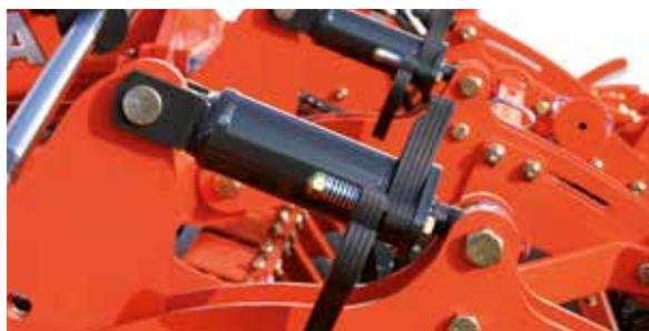
La profondeur de travail peut facilement être réglée par des entretoises pivotantes, qu'elle soit manuelle (uniquement sur les modèles portés) ou hydraulique.
