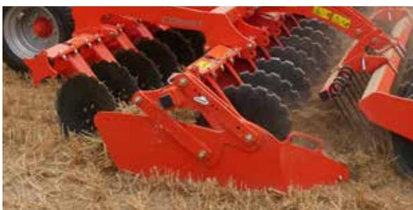
Les déflecteurs latéraux droit et gauche sont réglables en largeur et en hauteur, ils contrôlent le flux de terre pour assurer une finition parfaite. Tous les disques travaillent à la même profondeur, même les disques extérieurs. Les déflecteurs latéraux sont montés en parallélogramme, ce qui leur permet de suivre les contours du sol et de contrôler le flux de terre en même temps.
