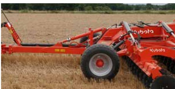
Sur les modèles semi-portés, des roues de jauge de 340/55x16 (option) peuvent être montées devant les disques pour assurer une meilleure stabilité de la machine et un contrôle constant de la profondeur pendant le travail, qui est indispensable à faible profondeur. La profondeur de travail peut être facilement réglée par des entretoises au niveau des vérins de profondeur comme pour les rouleaux.
