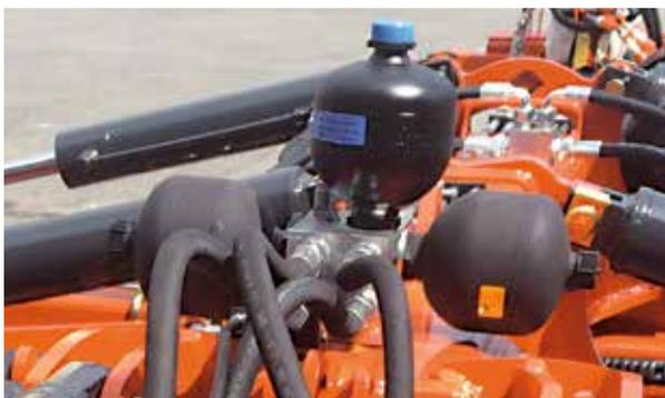
Les CD1000T et CD2000T sont extrêmement stables car ils sont équipés d'un dispositif de suspension double qui protège le châssis contre les contraintes pendant le transport, augmente énormément la stabilité de la machine pendant le travail grâce à la suspension de l'essieu et supprime les mouvements perturbateurs.
