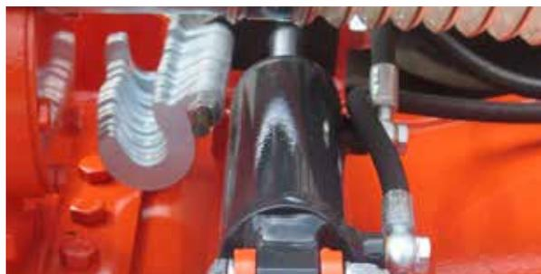
Sur les herse rotatives à repliage hydraulique, le réglage de la profondeur de travail est assurée par des cales, placées sur les vérins. Grâce à un parallélogramme, la herse rotative est toujours horizontale par rapport au rouleau. Par conséquent, la barre de décrochage du rouleau est à hauteur fixe et ne dépend pas de la profondeur de travail.
