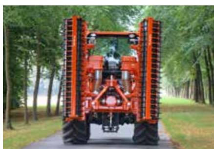
Sur les herse rotatives repliables Kubota, la transmission renvoie la force sur les côtés de la machine. De chaque côté, une boîte de vitesses, équipée d'une protection contre les surcharges assure un transfert fiable de la force jusqu'à 350CV. Réglé à 1000 tr/min à la prise de force, la vitesse des rotors varie de 336 à 450 tr/min. Le modèle PH3000F est équipé d'une boîte de vitesses à régime variable.
