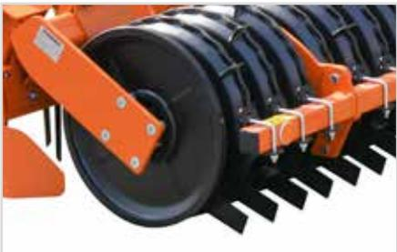
**Rouleau Cracker Packer Ø 550 mm - 200 kg/m.**
