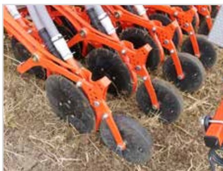
Élément semeur CX-II à double entrée, semez deux produits en un seul passage.
